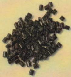
素材を配合後、溶かしてチューブ状に押し出し、2～3mmの長さで切断します。これを「ペレット」と呼びます。
